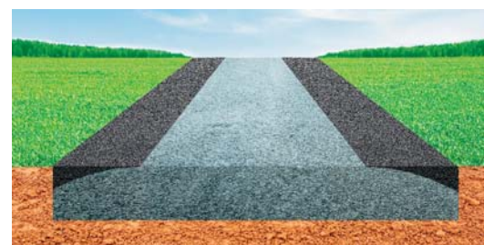
Reprofilage à la niveleuse ou au F.I.R..
