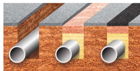
Bouchage de tranchées.
